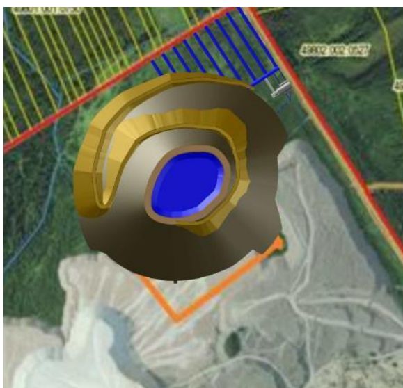
Joonis 3. Illustratiivsed näited maapealse ehitise kõrguse ja veekoguse suhtest (mida kõrgem maapealne alustarind (vasakpoolsel pildil), seda väiksem maapealne ja vastavalt sellele ka maa-alune veereservuaar). Allikas Estonia PHEJ eskiisprojekt
