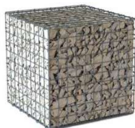
Foto 8. Vasakul: projekti jaoks sobiv 50x50x50 tagasihoidliku 7,5x7,5 cm silma mõõduga gabioonikorv – kaks korvi üksteise peale kinnitatuna moodustavad 0,9 meetri kõrguse seina (Allikas: ABPolar). Paremal: näide
